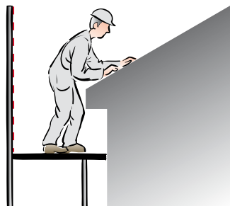
Byggnadsställning vid tak- och takfotsarbete.
